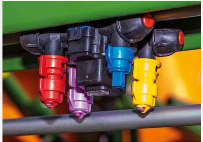
✔ Elektrische Einzeldüsenhaltung AmaSelect
