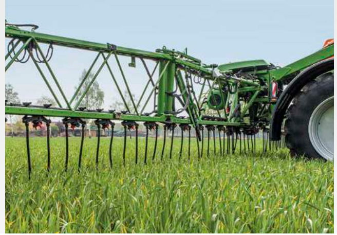
Schleppschlauchausstattung mit AmaSwitch 4-fach und Verlagerungs- satz am Super-L2-Gestänge
