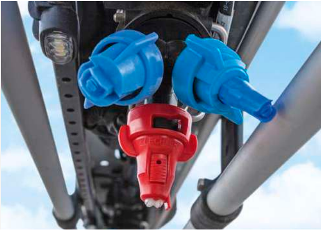
✔ Elektrische Einzeldüsenhaltung AmaSwitch
