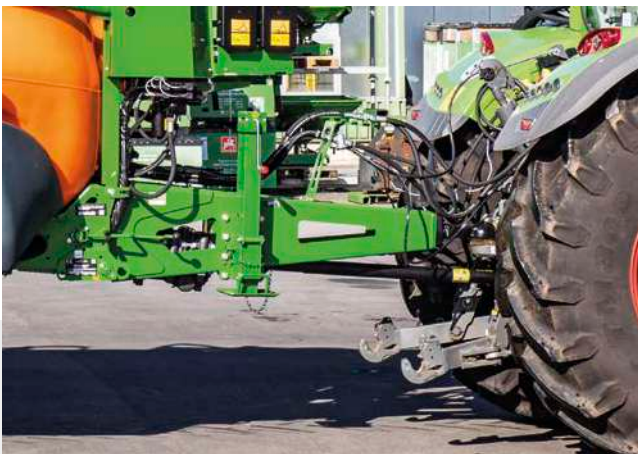
Obenanhängung mit Zugkugelpkupplung und mechanischem Stützfuß
